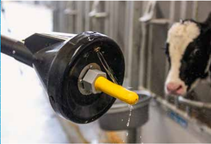
Nach jedem Kalb sprüht der Roboterarm den Nuckel mit Wasser von Außen ab und fährt dann zur nächsten Box.
