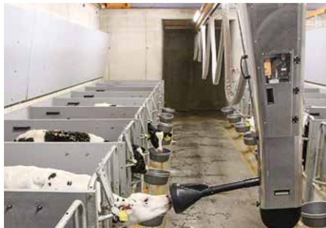
Die Roboterarme hängen an Schienen und bewegen sich von Box zu Box. Die Milch wird aus den Tränkeautomaten gepumpt.
